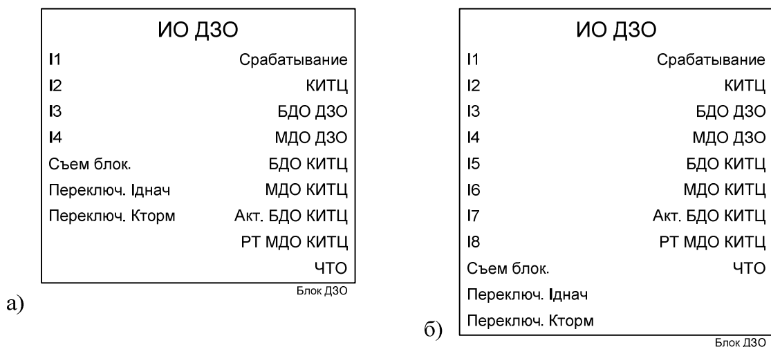
Рисунок 2 – Функциональные блоки ИО ДЗО (одна фаза)
